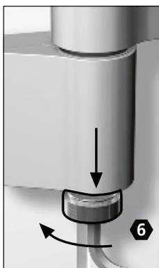
2. Hebespindel heraus-schrauben
