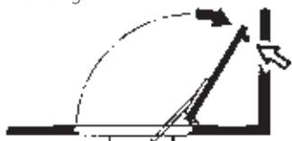
Maximalen Türöffnungswinkel durch einen Türstopper oder durch den Einsatz der GEZE T-STOP-Gleitschiene begrenzen.
